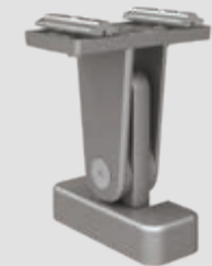
Stützfuß top für Reihenanlagen, verstellbar, in 3 Höhen: 120–165, 165–210 und 210–255 mm
